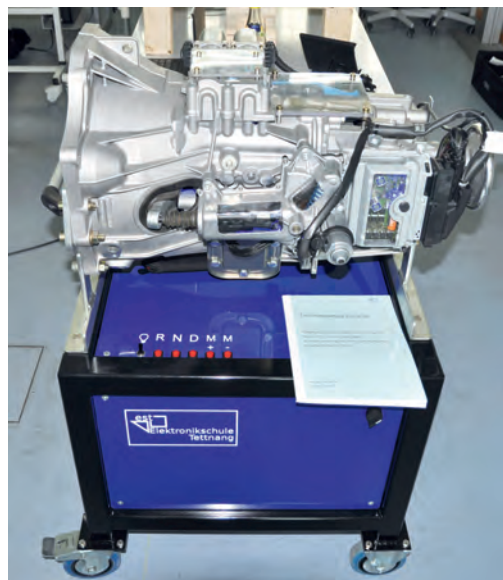
Funktionierendes Vorführmodell des automatisierten Schaltgetriebes
